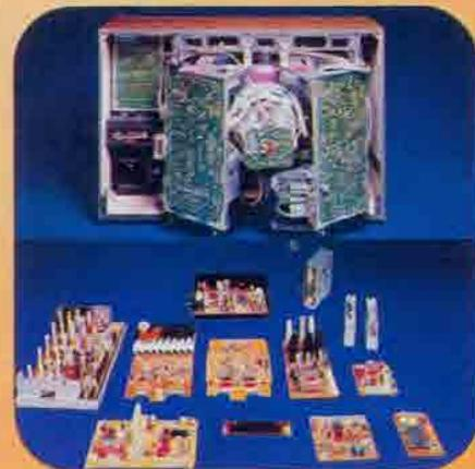
Modultechnik, die diesen Namen auch verdient. SABA Moduln sind in sich geschlossene Funktionseinheiten, die auf dem Zwei-Flügel-Chassis einzeln gesteckt sind. Selbst die Leitungen sind steckbar. Der Service-Techniker kommt also ohne zeitraubende Lötarbeiten aus. Mit wenigen Handgriffen kann der geübte Techniker die Funktionsmoduln auswechseln. Der Vorteil der SABA Modultechnik für Sie: Der Service wird einfacher, schneller und qualitativ besser.
